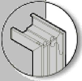
Jamba de bisagras cal. 16, 5 3/4", modelo SD 7'0" con preparaciones para 3 bisagras de 4 1/2" x 4 1/2" IZQUIERDA ACABADO FINAL EN PRIMER ANTICORROSIVO COLOR GRIS
